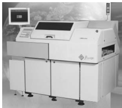
Рис. 1. Внешний вид установки комплексного тестирования GR Pilot LX
