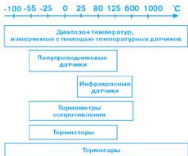
Рис. 1. Зависимость диапазона измеряемой температуры от типа датчика
